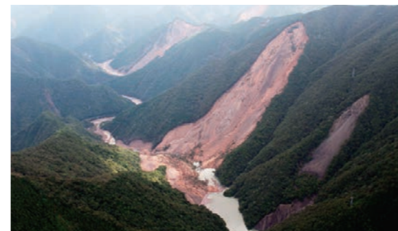
2011年台風12号による奈良県五條市大塔町赤谷の河道閉塞状況 資料提供/NPO法人 砂防広報センター
