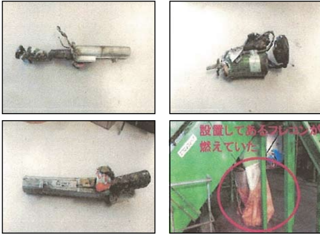
ノートパソコンの充電式バッテリーが混入。選別ラインの手選別工程でプラスチックが燃えているのが発見され、その先にあるフレコンバックも燃えていた
