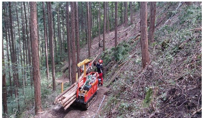
写真 1：運搬車での木材搬出作業
