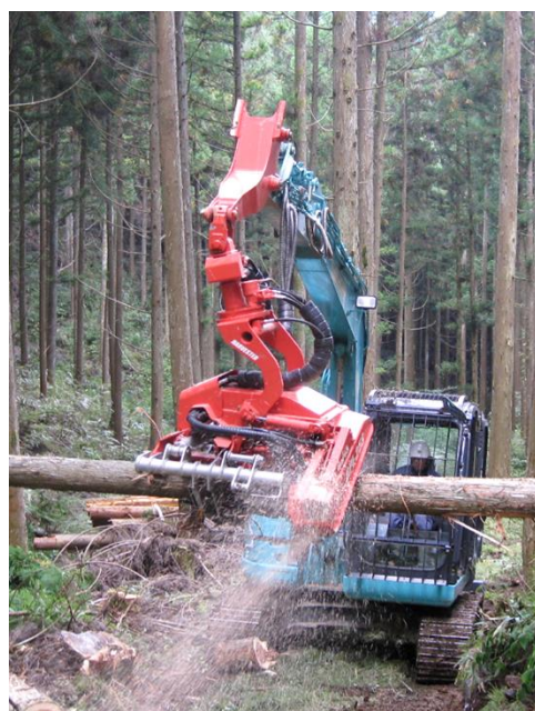
写真 4：高性能林業機械（ハーベスタ）で木材の伐採
