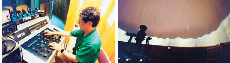
当館では太陽が沈む様子、夕焼け空から夜空に変化する動きや星座の投影など、すべての動作を手動で行っています。使用するつまみは10個とスイッチ類が10数個、投影中はそれらを操作しています。特に夕焼けや朝焼けのシーンでは8個のダイヤルを同時に手動で操作するため操作が大変です。小さなプラネタリウムならではの“職人芸”が、舞台裏では繰り広げられています。
