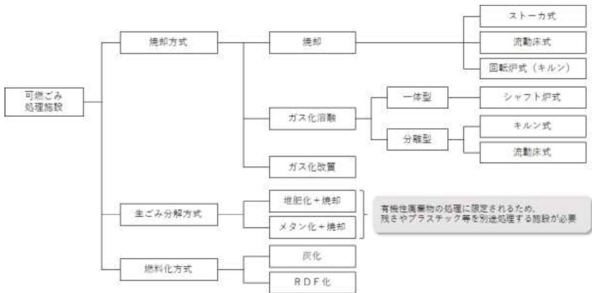
図 5-2 可燃ごみの処理方式
