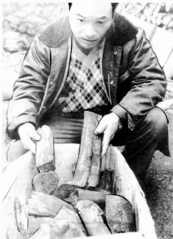
ドラム缶を土中に埋めて作った「西森式炭焼き窯」
