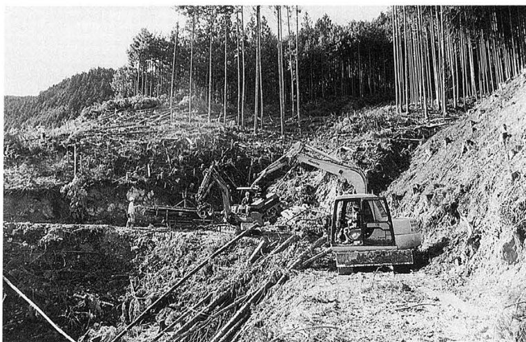
株いぶきによる木材伐出作業 (ジャガー グラップル プロセッサー) の組合せ作業
