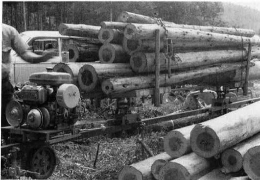
○ モノレールによる木材の搬出
