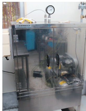
⑦瓶詰めしたジュースを入れて蒸気で殺菌する装置
